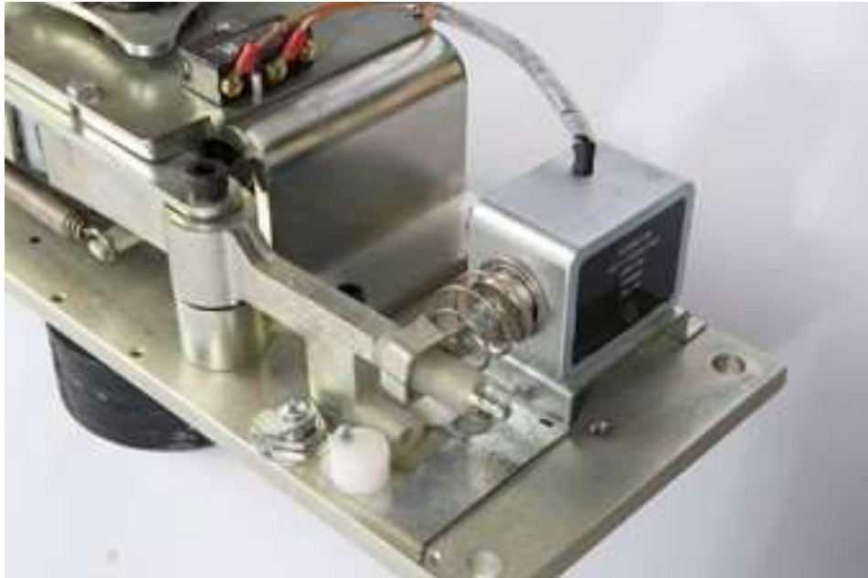
Abbildung 28: Solenoid im Fehlersicher Arrangement
